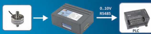
Przykład połączeń elementów zewnętrznych do wzmacniacza WDT1.
